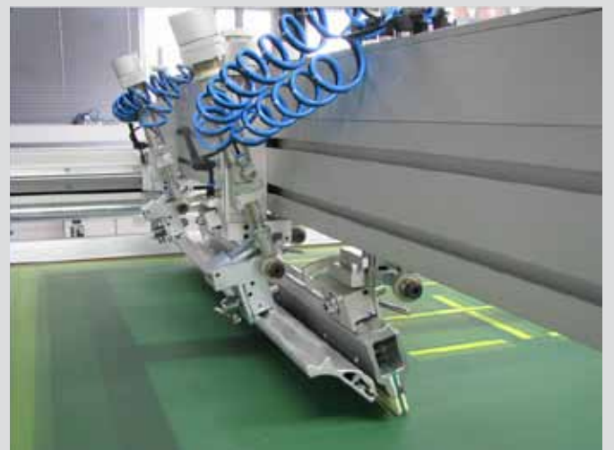
Abb. 17: Antitropfeinrichtung beim Drucken Pic.17: Anti-drip unit by printing
