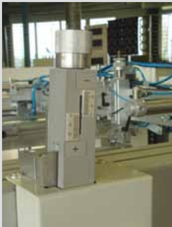
Abb. 20: Siebverzugskompensationseinheit an der THIEME 1000 E
