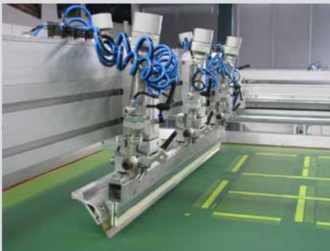
Abb. 16: Antitropfeinrichtung beim Fluten- Pic.16: Anti-drip unit by flooding
