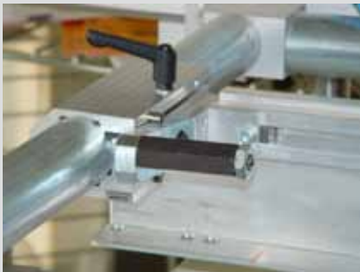
Abb. 7: Anschlag (in hochgeklappter Form) zur Siebrahmencentrierung
